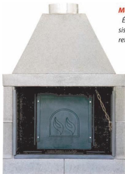
**Modello tipo chiuso:** Il piano fiamma e il parafuoco sono interamente in ghisa. È stato concepito per essere montato a parete, ma vi è anche la possibilità di sistemarlo a angolo. È realizzato completamente in conglomerato di materiale refrattario. Viene fornito con valvola di regolazione del tiraggio dei fumi e griglia.
